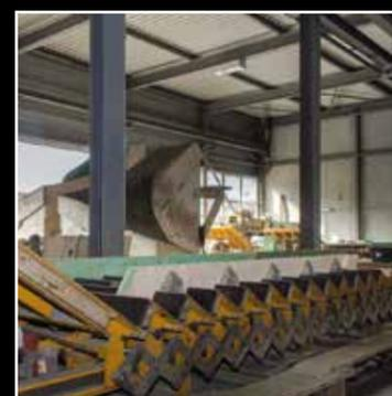
Coffrages métalliques normalisés et réglables avec ou sans palier intégré.
